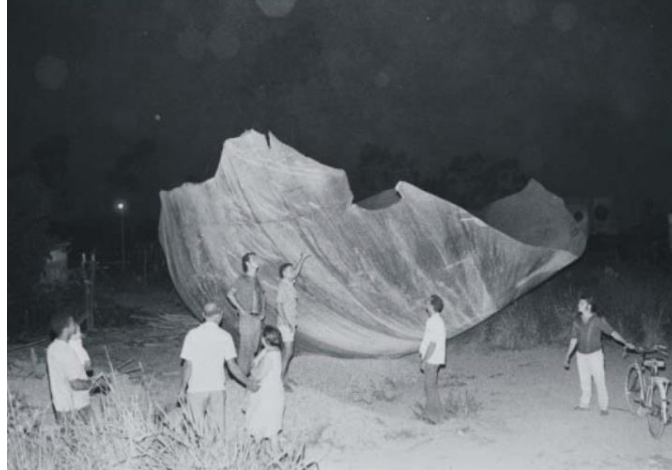
Figura 35: Tampão da esfera arremessada pela explosão. Fonte: http://inspecaoegipto.blogspot.com.br .
